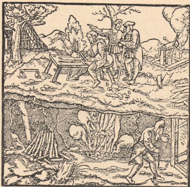
Rozbijanie skał zapomocą kolejnego działania ognia i wody. Robotnik u góry nakłada wiory na każdą wiązkę chróstu. U dołu górnik po zapaleniu ognia ucieka przed dymem. Z książki Agricoli.
