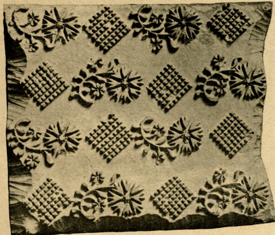
Eine geschnitzte Druckplatte für Webeleinen
