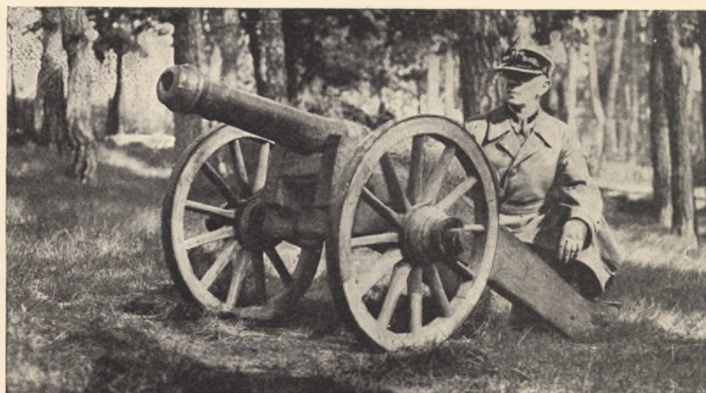
Rys. 59. 32 mm. armatka szkolna XVII. w. (dług. lufy 27 kal.). Zbiory Bractwa Strzeleckiego w Toruniu.
