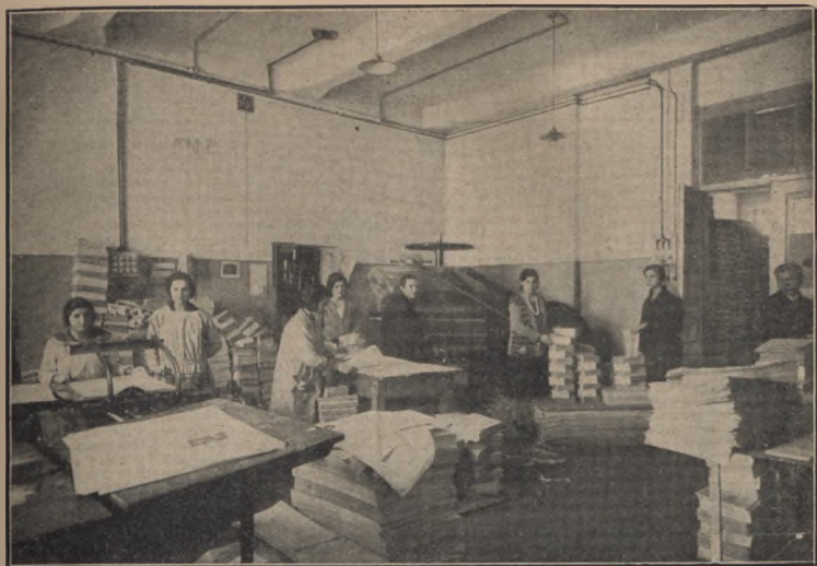
Introligatornia. Na lewo falcówka. W głębi nóż maszynowy.
