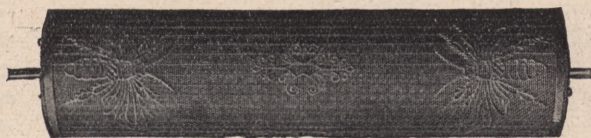
T. zw. egoutteur, wałek do tłoczenia znaków wodnych
